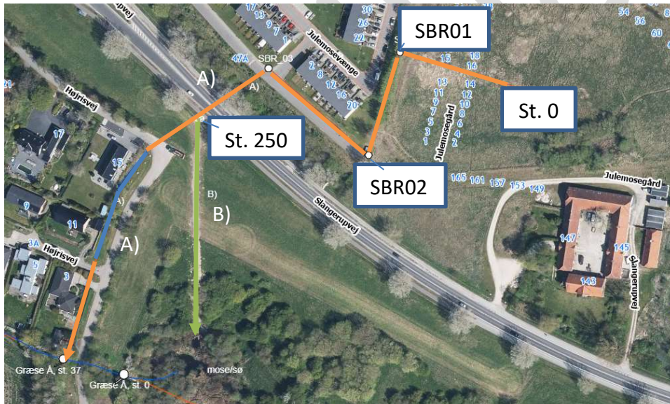
Figur 1. Udsnit af luftfoto 2023. Det private rørlagte vandløb, strækning A) og B), er illustreret på kortet. Vandløbet begynder på Julemosegård, nord for Slangerupvej, og udløber syd for Slangerupvej i henholdsvis A) en grøft hvorfra vandet løber til Græse Å, st. 37 via en rist i bunden af grøften, henholdsvis B) en sø/mose (opstrøms Græse Å, st. 0). Vandløbsstrækning A) er markeret med orange og blå streg. Vandløbsstrækning B) er markeret med grøn streg. Eksisterende vandløbsbrønde SBR01 og SBR02 ses beliggende på strækning A, nord for Slangerupvej.
